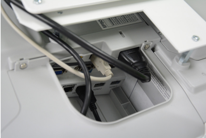
Podłączenie przewodów HDMI, zasilania oraz USB
