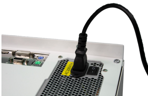
Podłączenie przewodu zasilania skrzynki komputerowej
