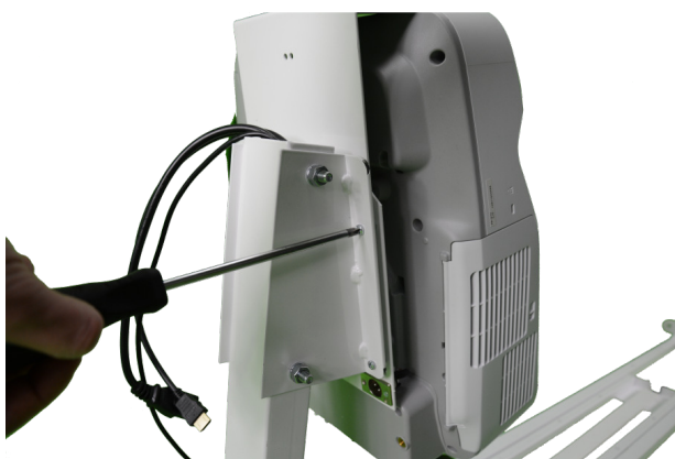
Montaż projektora za pomocą śrub
