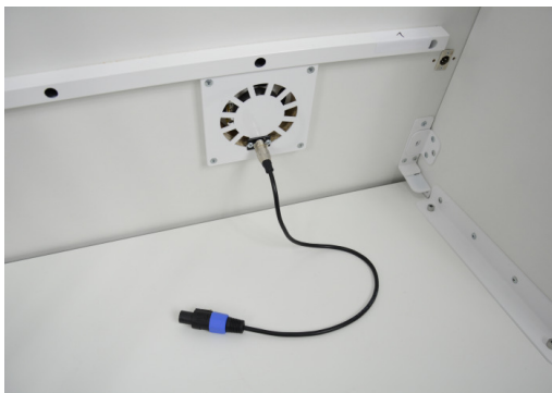
Podłączenie przewodu głośnikowego
